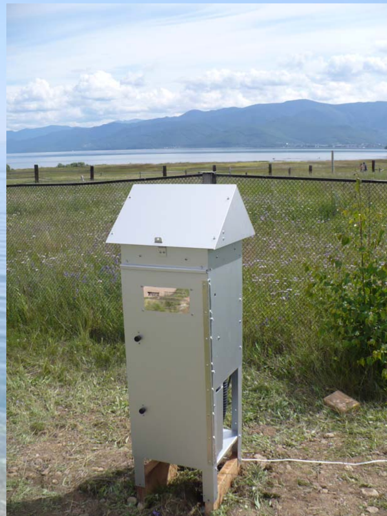
Активный концентрирующий пробоотборник в п.Култук, Байкальский ЦГМС (установлен в июле 2013 года)
