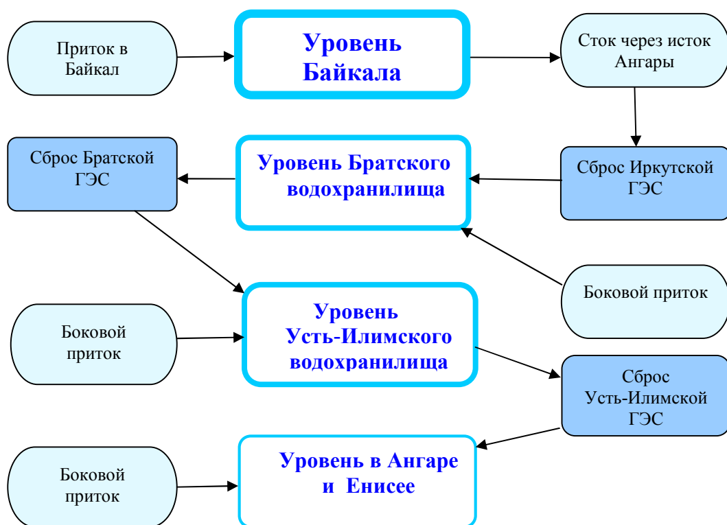
Рис. 1.1.1.1.2. Зависимость уровня Байкала от сбросов ГЭС Ангарского каскада
