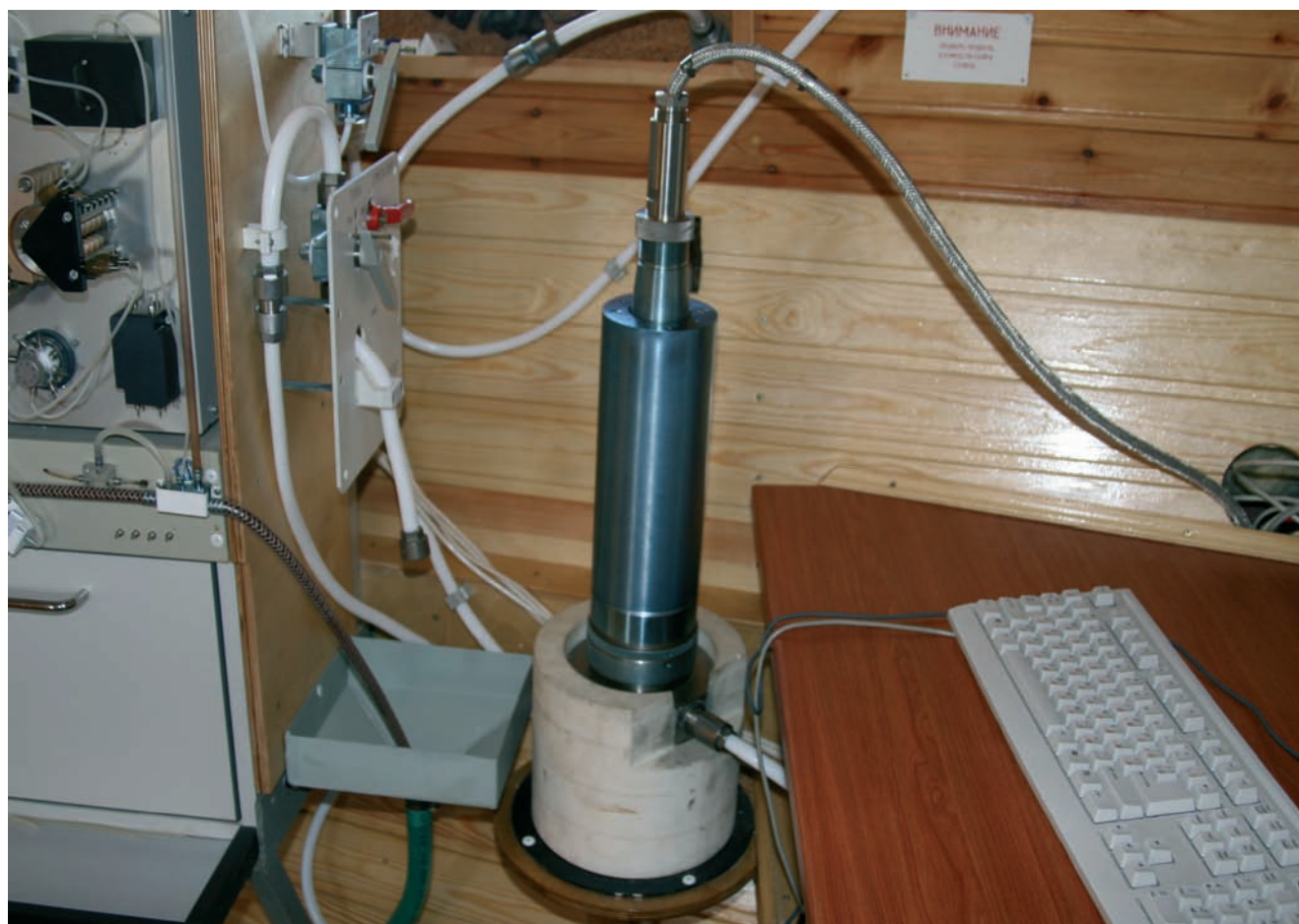
Рис. 2.4.4. Блок непрерывных гидрохимикофизических измерений (температура; удельная электропроводимость, pH, Eh, O 2 )
