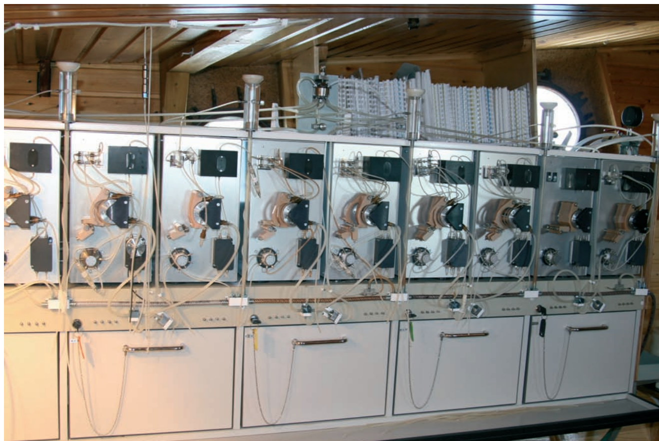
Рис. 2.4.3. Гидрохимические анализаторы непрерывного действия (хлорид-ион, сульфат-ион, фосфат-ион, нитрат-ион, аммоний-ион, АПАВ, нитрит-ион, железо, медь, цветность)
