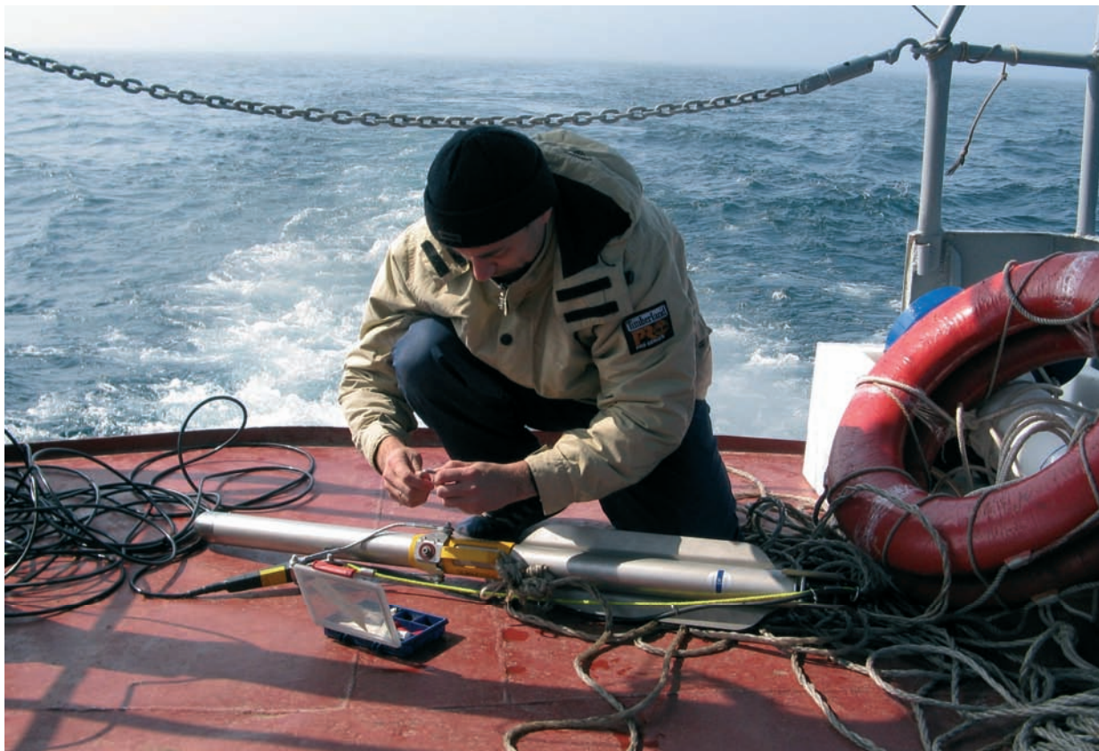
Рис. 2.4.5. Гидролокатор бокового обзора CM2 С-Max. Подготовка к буксировке.
