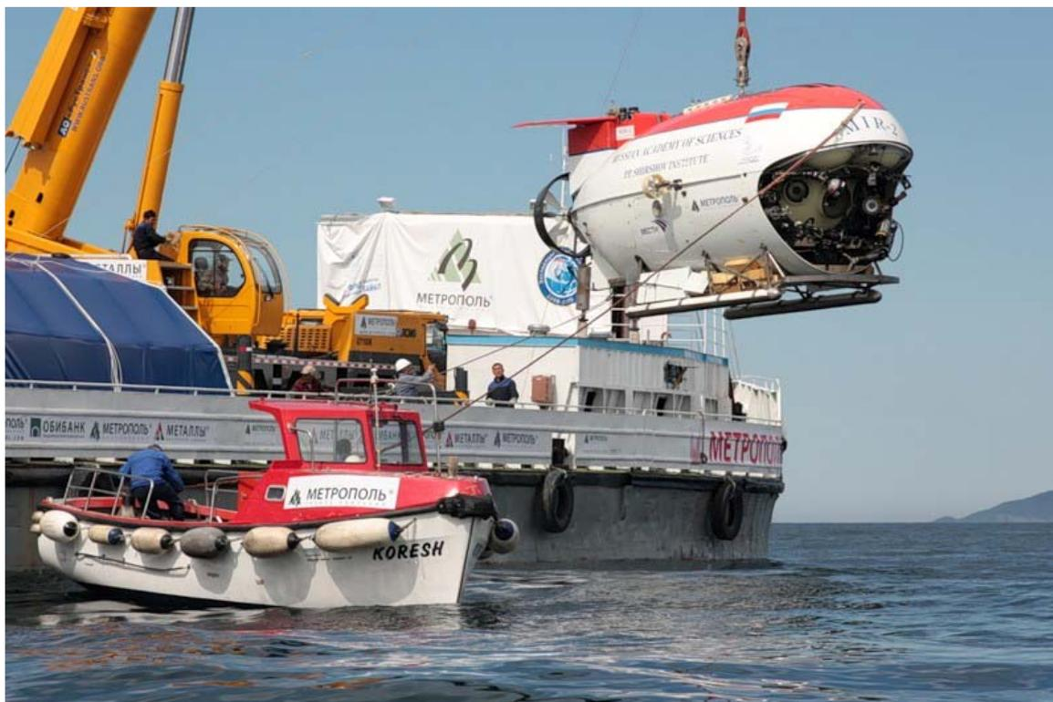
**Рис. 1.2.2.4.1. Спуск глубоководного обитаемого аппарата «Мир-2» с баржи «Метрополь» на поверхность озера Байкал**
