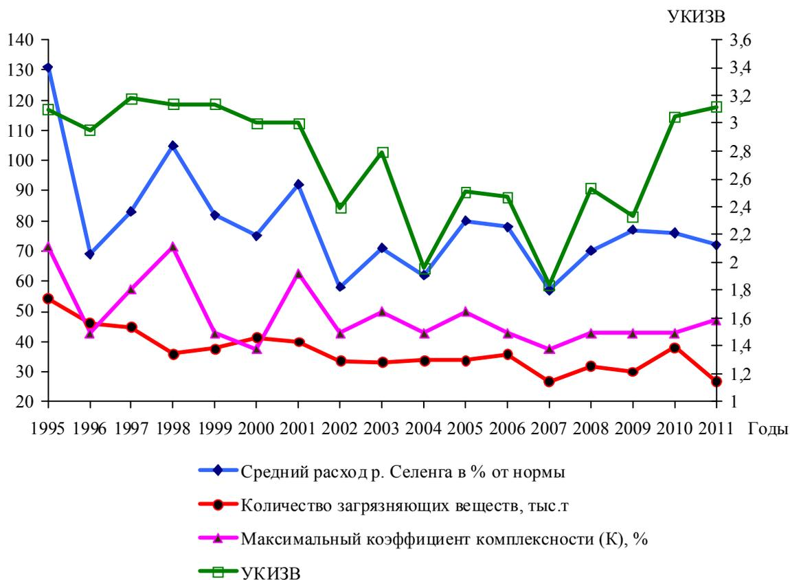
**Рис. 1.2.1.1.3. Зависимость максимального коэффициента комплексности (K) и удельного комбинаторного индекса загрязненности воды (УКИЗВ) от водности р. Селенга и количества загрязняющих веществ в воде реки за период 1995-2011 гг.**
